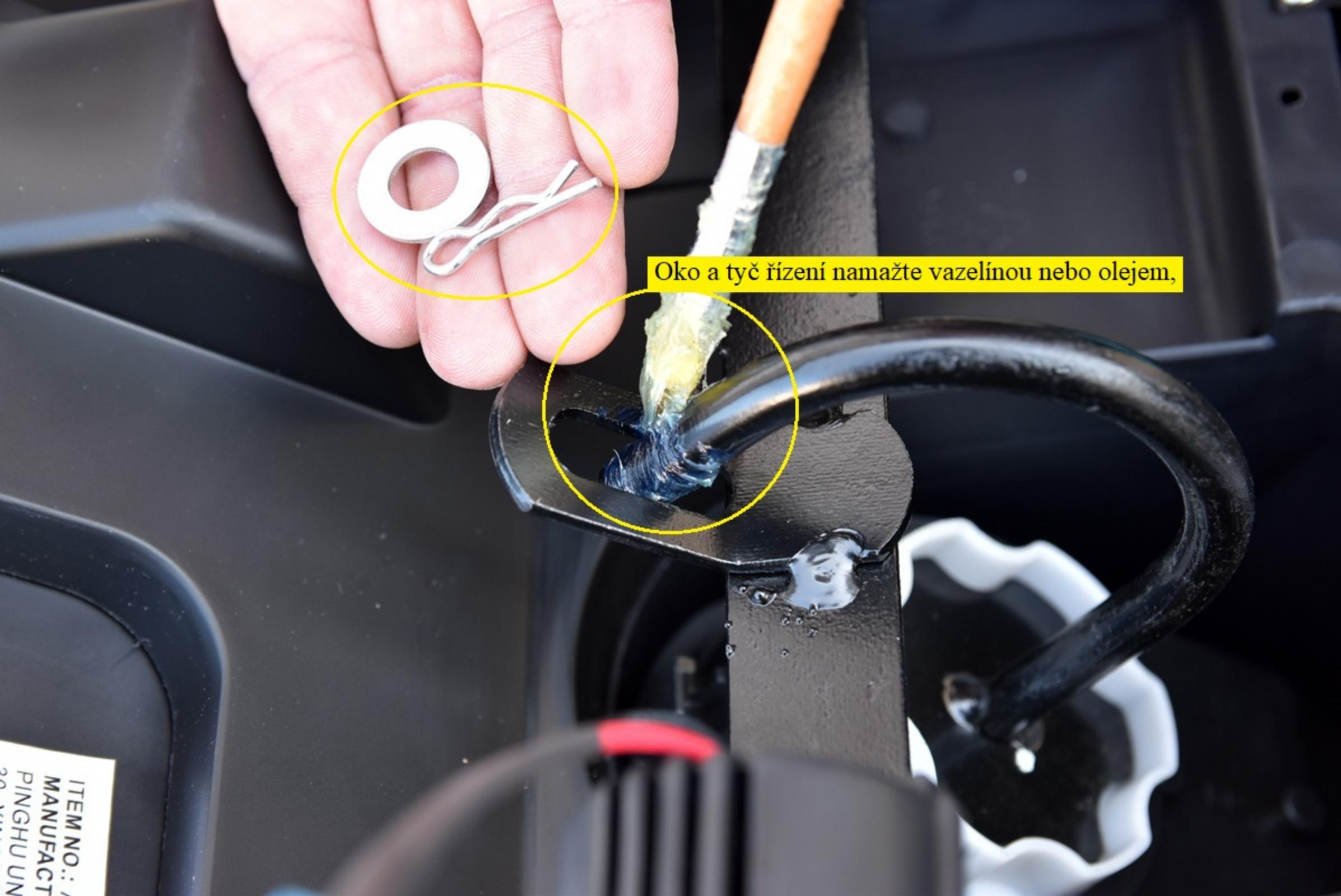
Oko a tyč řízení namažte vazelínou nebo olejem,
