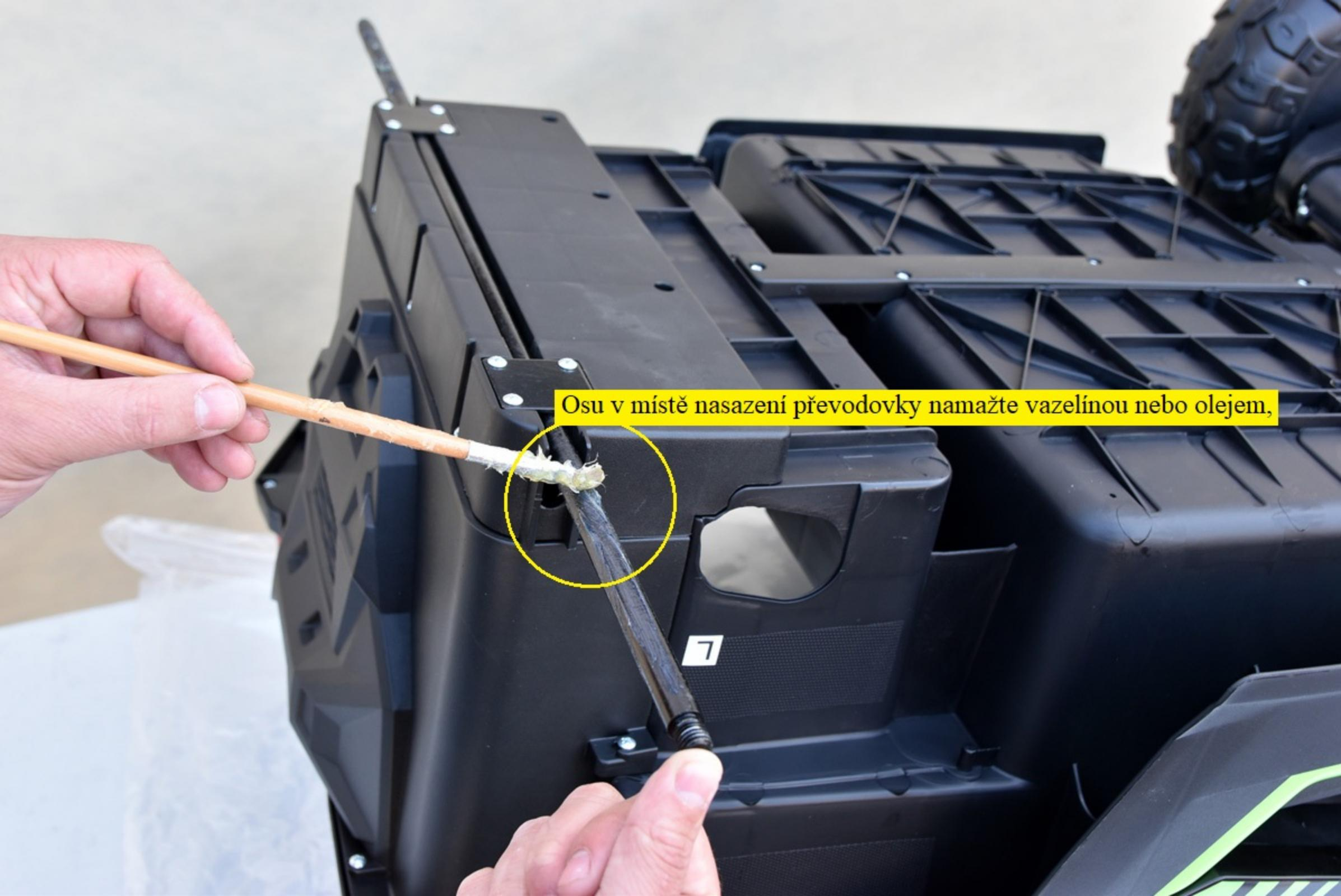
Osu v místě nasazení převodovky namažte vazelínou nebo olejem,
