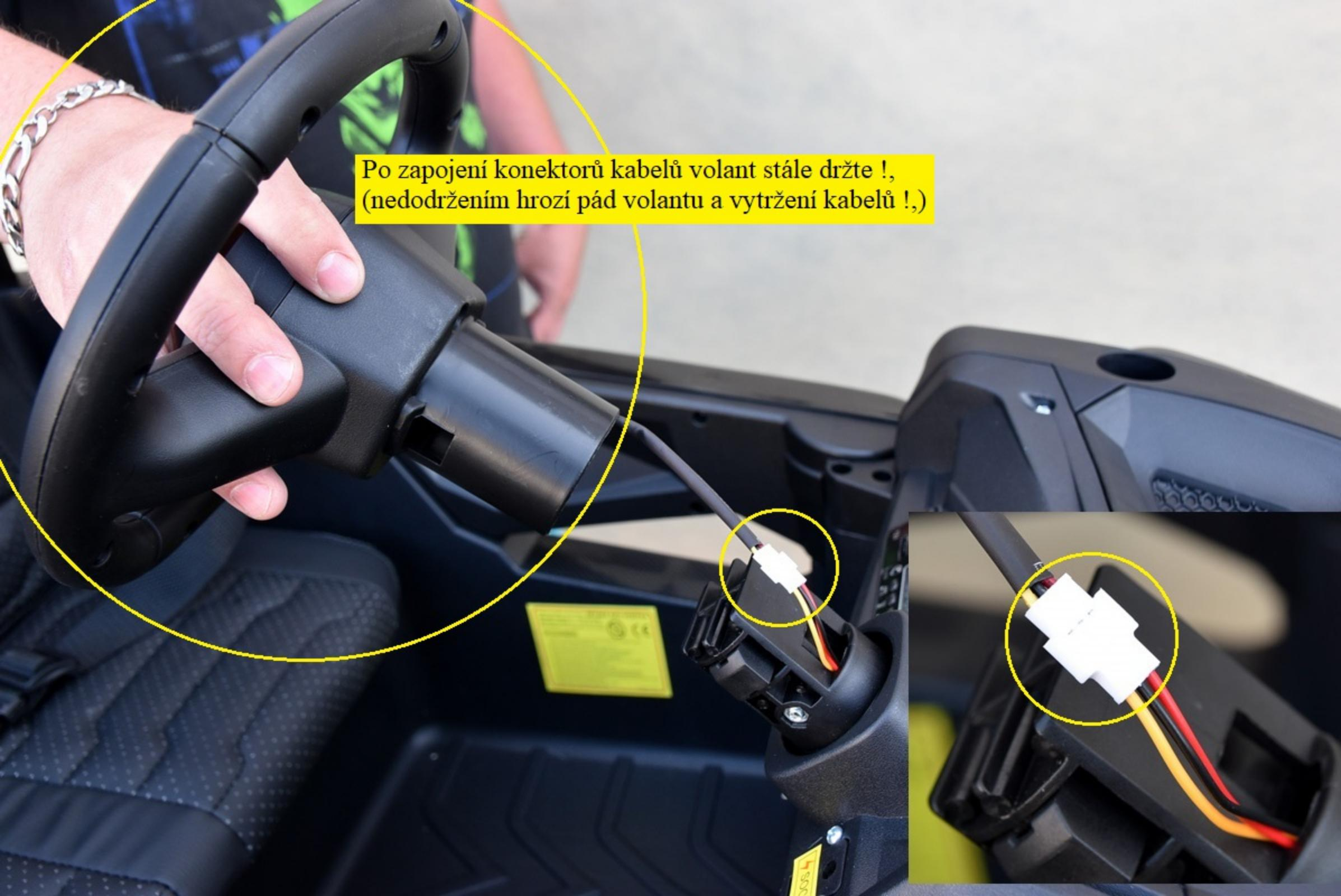
Po zapojení konektorů kabelů volant stále držte !,
