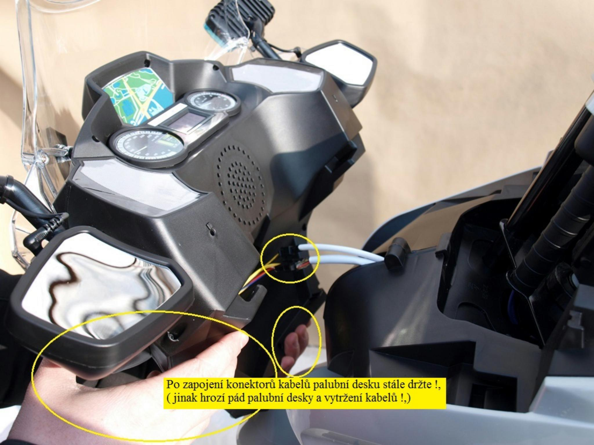
Po zapojení konektorů kabelů palubní desku stále držte !,
