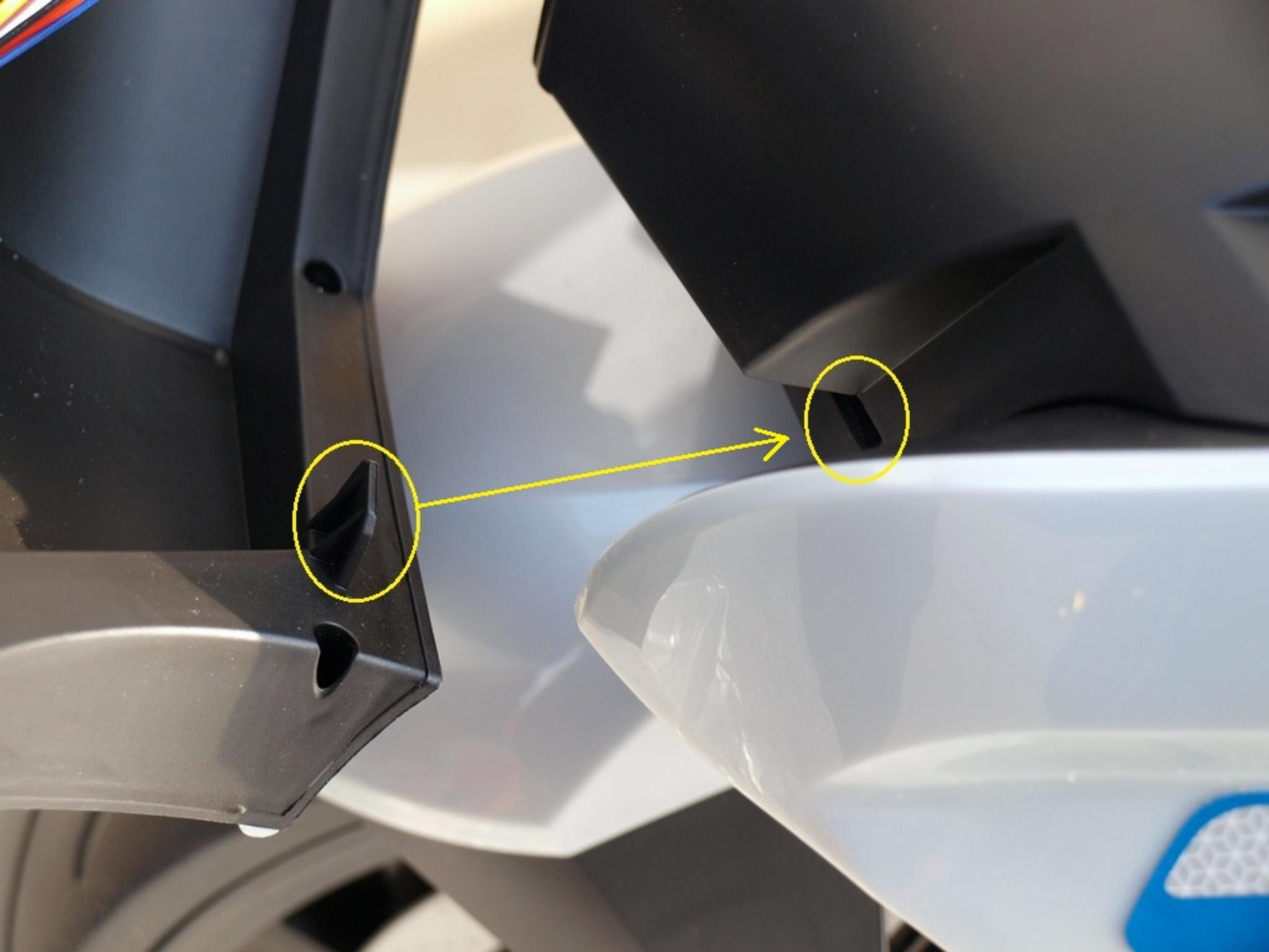
Zapojené kably a konektory srovnejte a zastrčte do otvoru palubky, až poté nasadťte palubní desku na motorku,
