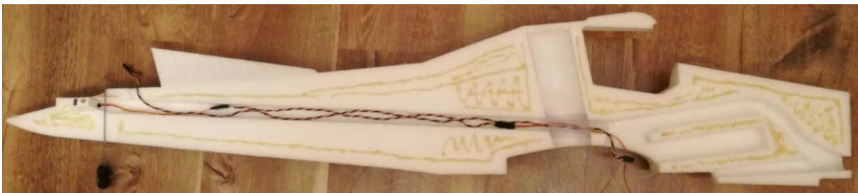
Obě části VOP slepíme k sobě a vyztužíme uhlíkovou pásnicí 5x0,6mm po celé délce z jedné strany. Do výškovky v ose serva zařízneme ovládací páku. (1 ze 4ks - tvarově odlišných od závěsů klapek) VOP pečlivě přilepíme purexem na trup. Po dobu tvrdnutí kontrolujeme kolmost k trupu. (Po okraji opět můžeme přichytit CA lepidlem).
