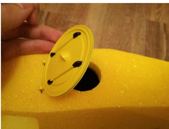
V případě zakoupení rozmetadla, je součástí i poklop „kotle“. Po nabarvení provlékneme očky drát ohnutý do tvaru „U“, zapíchneme a zalepíme do epp.
