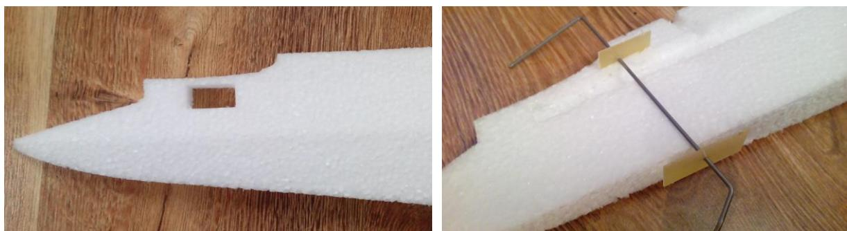
V přední části trupu, dole, vydlabeme dostatečný prostor pro regulátor. Drážku pro napájecí kabely vyvedeme na začátek centroplánu a dopředu k motorové přepážce. Stejně tak pro Aku.
