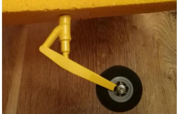
Po nabarvení modelu přilepíme CA lepidlem maketu ostruhy na ostruhový drát. (Vršek nohy případně zkrátíme dle potřeby). Lepidlo nanášíme opatrně, aby se nevytlačilo a nepřilepili ji k trupu!
