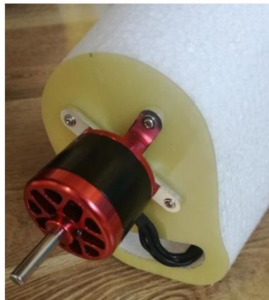
Přilepíme motorový kryt – stačí na čtyřech místech. U ostruhy opatrně přilepíme zbývající sklotextit, abychom nezalepili samotný drát. Kolečko zajistíme stavěcím kroužkem.
