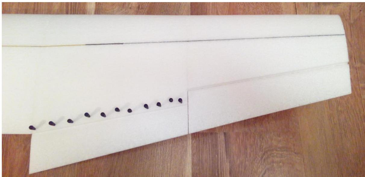
Do klapek zařízneme pravoúhlé páky tvořící panty v rozteči 120 mm. (Kratší klapky v centroplánu – rozteč 130mm.)
