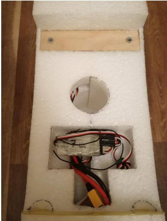
V trupu vydlabeme dostatečně velký prostor pro přijímač a ostatní kabely – nejlépe naproti „kapse“ v křídle.
