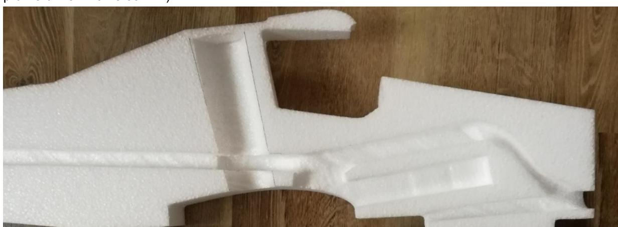
Do vytvořených drážek vložíme prodlužovací servokabely napojená na serva. Obě poloviny trupu slepíme k sobě purexem. Lepidlo naneseme plošně, 10-15mm od krajů – aby nevypěnilo ven. V místě ostruh také lepidlo vynecháme. Po srovnání obou polovin a sešpendlení, okraje postupně slepíme řídkým CA lepidlem. Nezapomeneme vytvořit drážku pro sklotextit i v opačné polovině.
