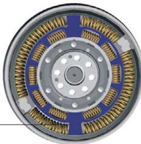
Dvoumotový setrvačnick s čtyřnásobným dělením a vnitřním tlumičem
